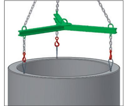
Bauteile mit Seilschlaufen
